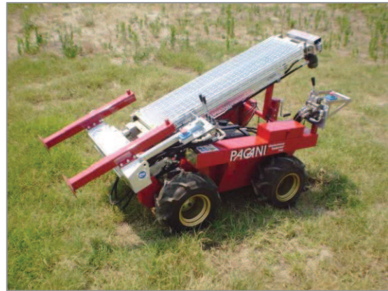
Figura 1. Penetrómetro dinámico para ensayos DPM Pagani TG 30-20
